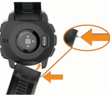
**POZNÁMKA:** Zkontrolujte, zda je řemínek rádně připevněn. Osička musí zavknout do příslušných otvorů na zařízení.
